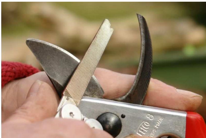
< EEN SLIJPSTAAFJE MET DIAMANTGRUIS (DEZE, VAN EEN LEATHERMAN TOOL, HEEFT EEN VIJL AAN DE ACHTERZIJDE) IS IDEAAAL OM DE SNOEISCHAAR STEEDS EVEN AAN TE SCHERPEN
